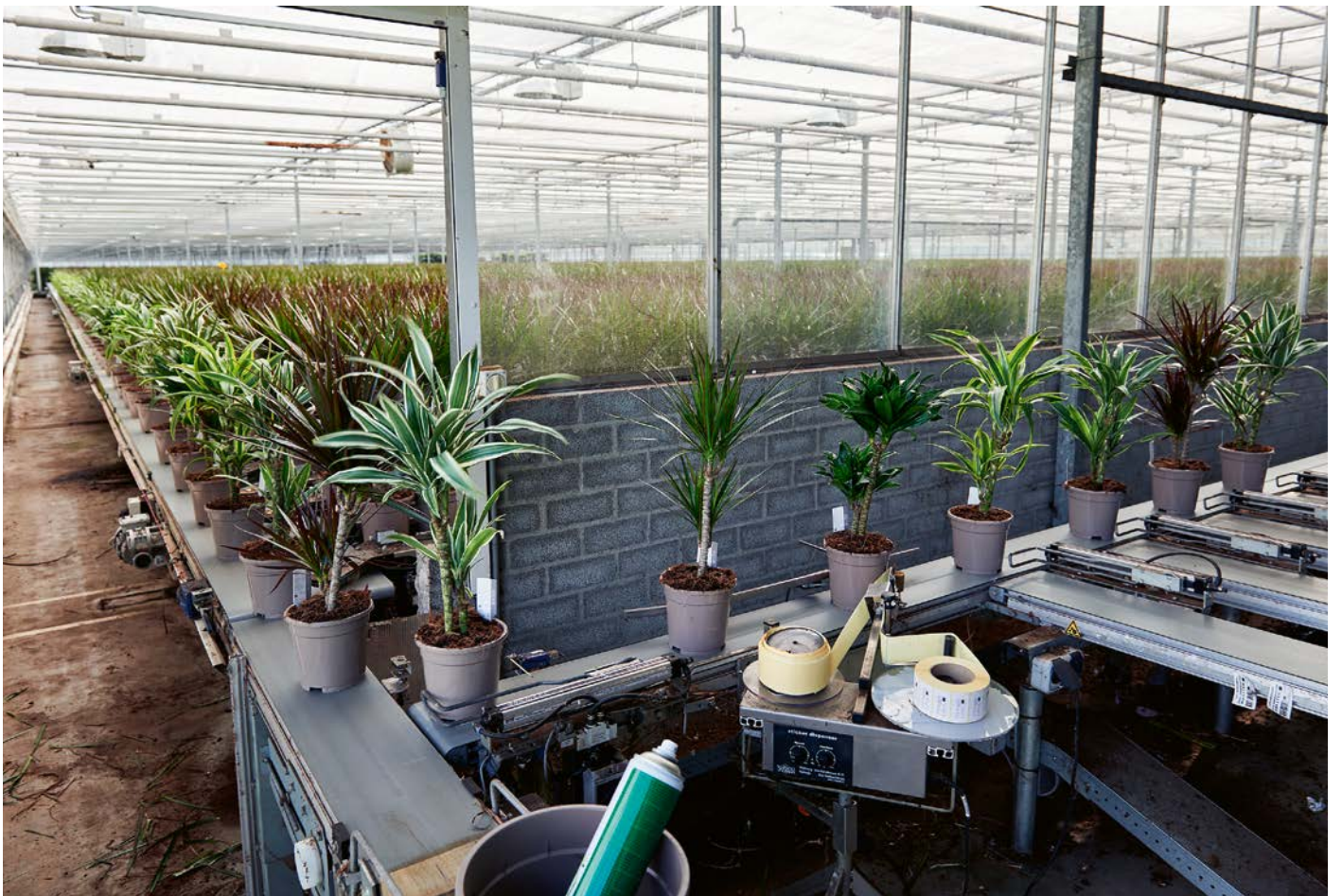
De computer weet exact de locatie van elke afzonderlijke plant. Het 'rapen' van de orders gebeurt dan ook volautomatisch.
